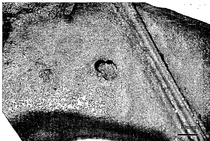
شکل ۳-۷: تصویری از شکستگی محل چپلت که در سطح کناری قطعه رخ داده است.
