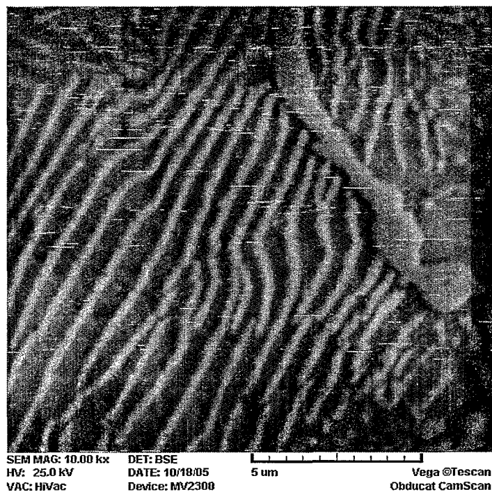
شکل ۵-۳۵: تصویر SEM از ناحیه پرلیتی با مرز دانه سمانتیت
